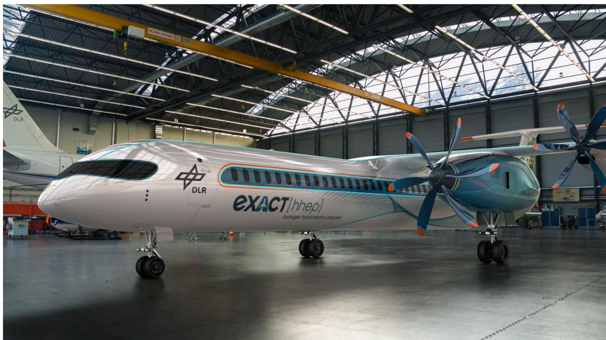
*DLR EXACT: aereo passeggeri per medie distanze con propulsione a idrogeno*
